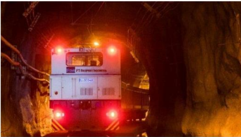
Gambar 7.2. Lokomotif listrik dikendalikan dari jarak jauh
