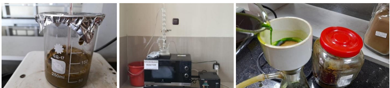
Gambar 4. Proses ekstraksi simplisia serbuk menggunakan metode microwave assisted extraction (MAE)
