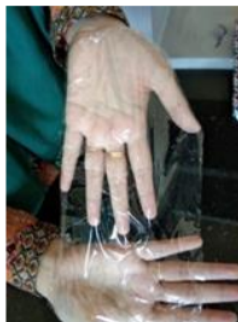
Gambar 1. Plastik agarosa-kitosan-minyak serai dapur (Agr-Chi-LEO)
