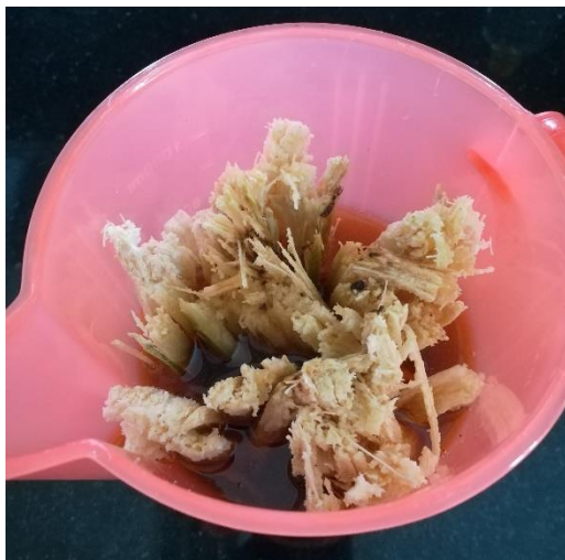
Gambar 2. Proses Penjernihan Minyak Jelantah Dengan Ampas Tebu
